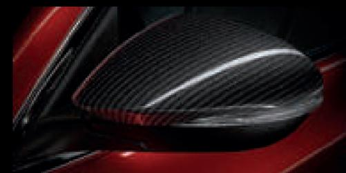
Capas dos retrovisores exteriores em fibra de carbono
