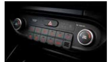
**Ar condicionado de duas zonas** Este sistema de climatização permite ao condutor e ao passageiro dianteiro regular a temperatura de acordo com as suas preferências individuais.
