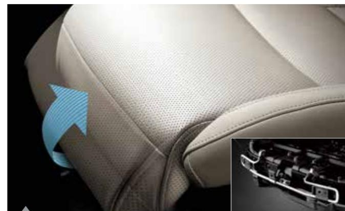
**Assento do banco do condutor com extensão elétrica** O assento do banco do condutor pode ser estendido, e foi pensado para um maior conforto dos condutores com pernas compridas.
