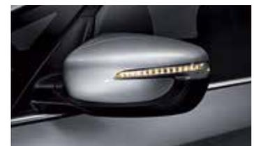
**Retrovisores exteriores** Os espelhos retrovisores exteriores elétricos retráteis, bicolores, têm incorporados indicadores de mudança de direção LED e luzes de iluminação do piso, para maior segurança e comodidade.
