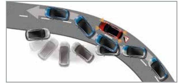
**ESC (Controlo Eletrónico da Estabilidade)** em caso de travagem repentina, o sistema ESC aplica a força de travagem necessária para cada roda. Também reduz a potência do motor para o ajudar a manter o controlo e fazer regressar o seu Carens à trajetória correta.
