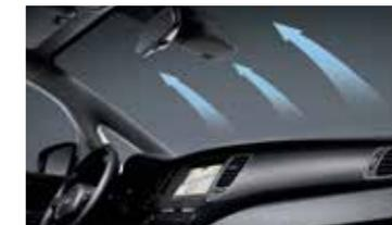
**Sistema de desembaciamento automático** O processo de desembaciamento é iniciado automaticamente por um sensor quando é detetada condensação nos vidros, assegurando a visibilidade ideal em climas húmidos.
