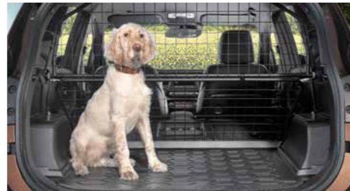
**Separador de carga** Esta robusta grelha é ideal quando necessitar de transportar o seu animal de estimação ou um grande volume de carga. Encaixando-se perfeitamente entre as costas dos bancos traseiros e o tejadilho, é fácil de instalar e permite transportar objetos com toda a segurança.
