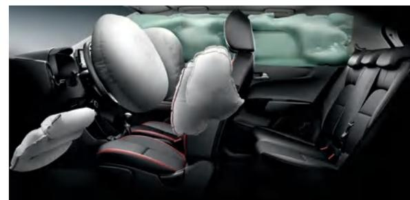
**Airbags frontais/laterais/de cortina.** Para ajudar a proteger os ocupantes e a diminuir os ferimentos em caso de colisão, o Picanto inclui airbags frontais para o condutor e para o passageiro dianteiro, dois airbags dianteiros laterais e dois airbags de cortina.
