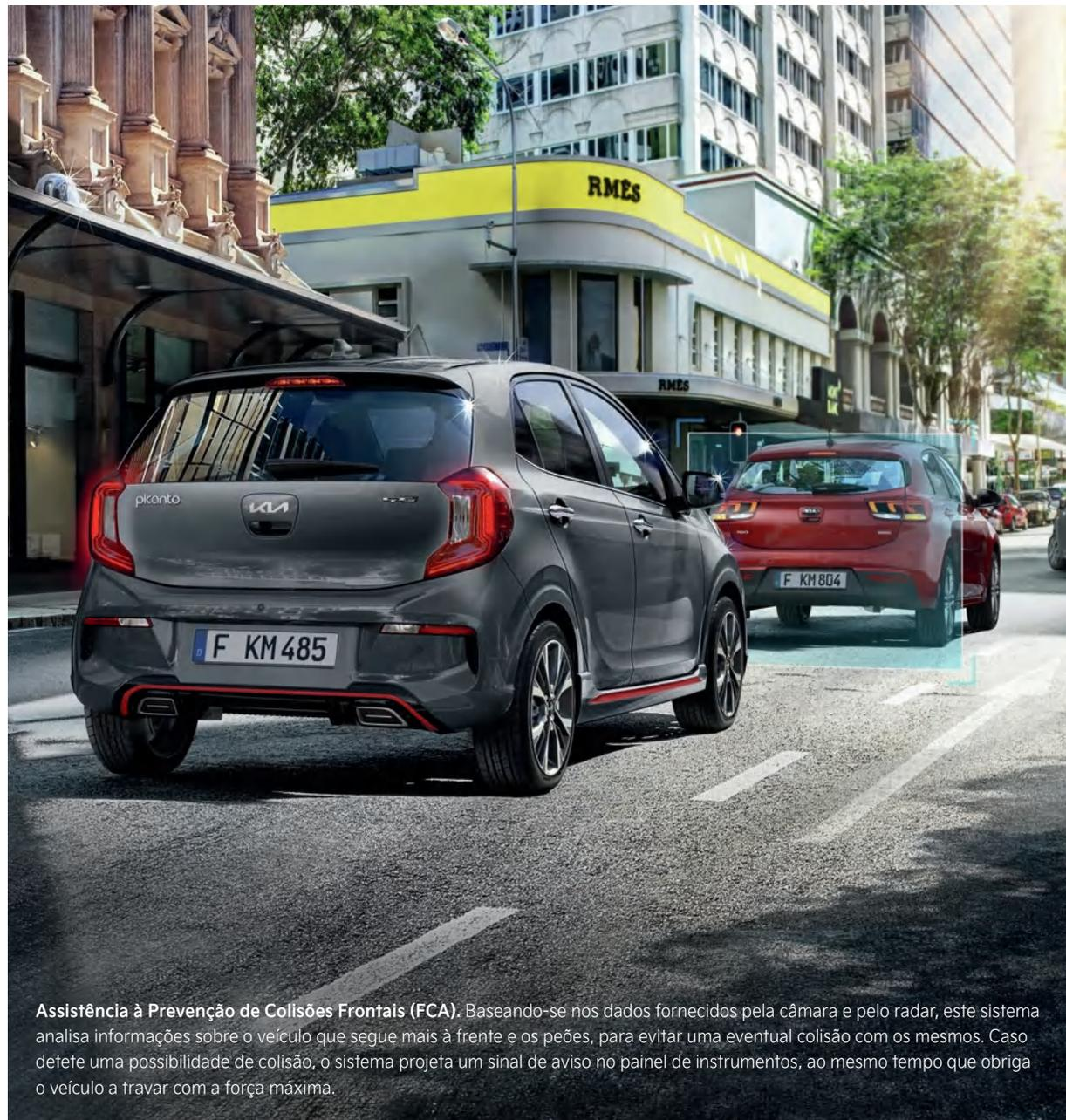
**Assistência à Prevenção de Colisões Frontais (FCA).** Baseando-se nos dados fornecidos pela câmara e pelo radar, este sistema analisa informações sobre o veículo que segue mais à frente e os peões, para evitar uma eventual colisão com os mesmos. Caso detete uma possibilidade de colisão, o sistema projeta um sinal de aviso no painel de instrumentos, ao mesmo tempo que obriga o veículo a travar com a força máxima.
