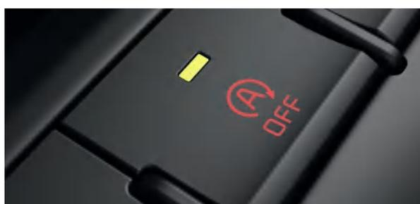
**ISG (Idle Stop & Go).** Concebida para reduzir o consumo de combustível, ao desligar o motor quando o veículo para no trânsito, a tecnologia ISG é equipamento de série em todas as versões do Picanto.
