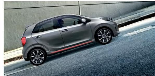
**HAC (Assistência ao Arranque em Subidas).** Quando parar numa subida, conte com o HAC para ajudá-lo a evitar que o seu veículo descaia. O sistema aciona suavemente os travões no momento em que o condutor levanta o pé do respetivo pedal, dando-lhe tempo para mudá-lo para o pedal do acelerador sem sobressaltos.
