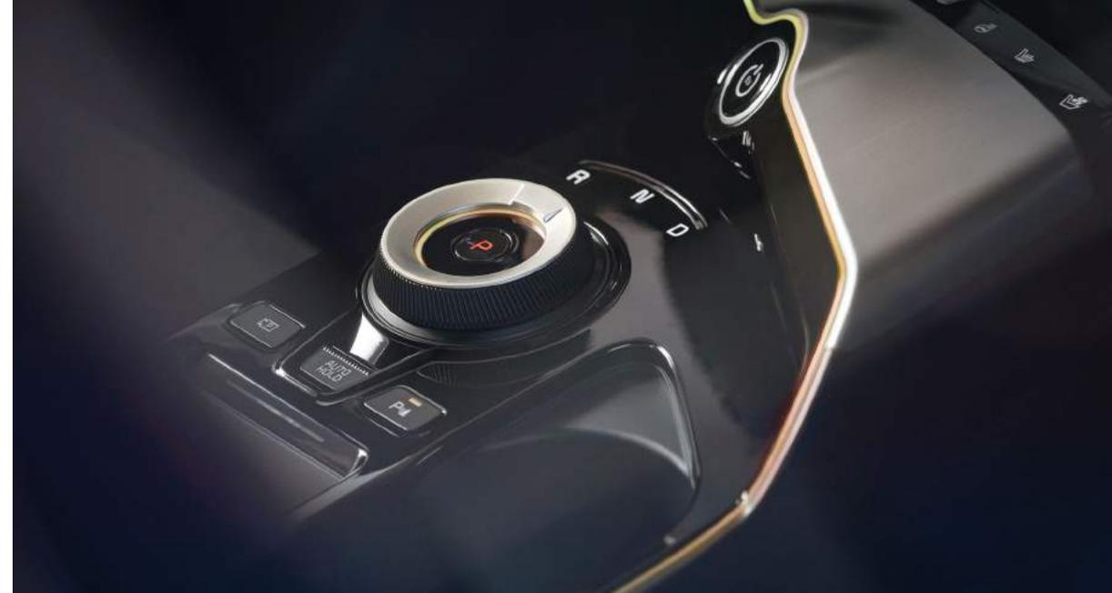
**Seletor shift-by-wire (SBW).** Para comutar entre marcha-atrás (R), neutro (N) e Condução (D), basta travar e rodar o botão do sistema shift-by-wire para a esquerda ou para a direita. Para ativar o modo de estacionamento, carregue no botão P.
