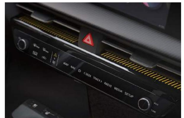
**Display comutável do infotainment/ar condicionado.** O display comutável oferece uma forma intuitiva de interagir com o veículo, mantendo ao mesmo tempo as informações úteis facilmente acessíveis. Prima o ícone do infotainment ou do ar condicionado, e depois os botões dos menus relevantes, para proceder aos ajustes que desejar.
