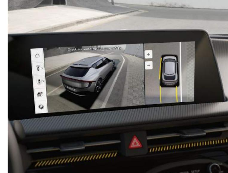
**Monitor do Espaço Circundante (SVM).** Nas manobras em espaços reduzidos, as diversas câmaras que equipam o seu veículo oferecem-lhe uma vista superior de 360°, que pode ser aumentada para lhe facilitar as manobras de direção e o estacionamento. Em suma: acabou a necessidade de sair do veículo para verificar distâncias até aos obstáculos, ou de pedir ajuda aos outros.
