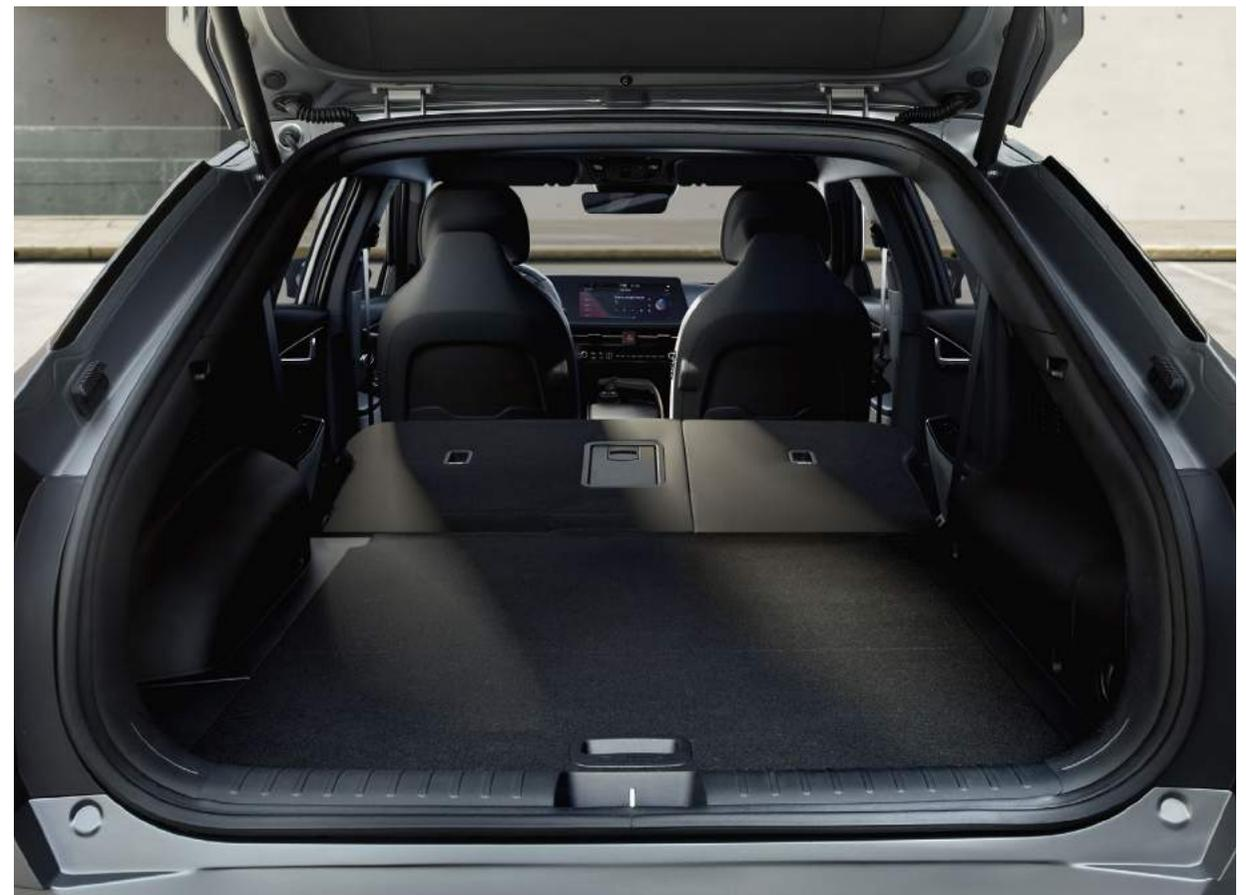
**Rebatimento remoto dos encostos dos bancos da 2ª fila.** Puxe a alavanca de desbloqueio remoto localizada na parte lateral da bagageira para rebater os encostos dos bancos da 2ª fila. Poderá então usufruir de uma capacidade de carga de 1300 l. A localização inteligente desta alavanca tornam-na num verdadeiro segundo par de mãos quando se trata de carregar objetos compridos ou volumosos.
